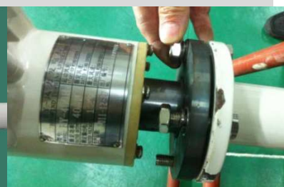
Setze Unterlagescheibe und Federring auf die Schraube auf und verschraube Flanche mit 60 Nm
