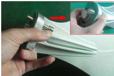
Nutze M8 Schrauben für die Montage der Fahne
