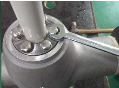
Ziehe die Schrauben mit 35 Nm an.
