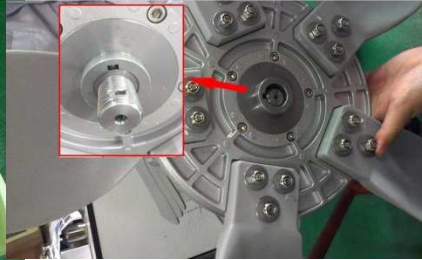
Schiebe die Nabenscheibe mit den Flügeln auf die Generatorwelle. Setze dann Unterlagscheibe, Federring und Mutter auf.
