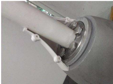
Schiebe die Abdeckungen auf den Verbindungsflansch
