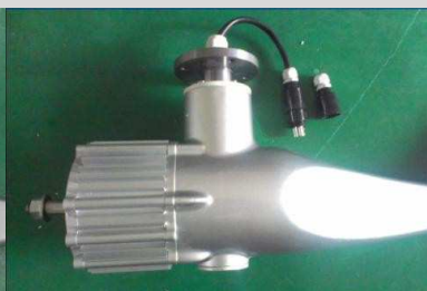
Schraube die Kappe der Anschlussklemme ab
