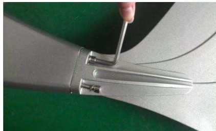
Ziehe die Schrauben mit 18 Nm an.
