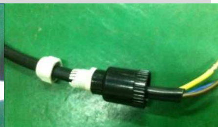
Führe das Kabel durch die Kappe
