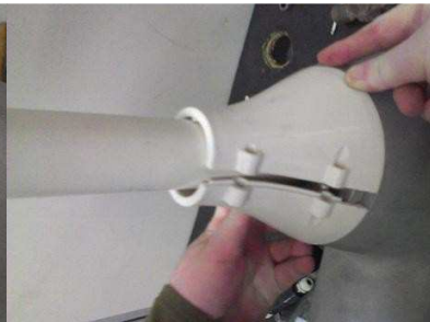
Verschraube die Abdeckungen und ziehe die Schrauben mit 5Nm an.
