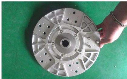
Führe die Sechskantschraube von hinten durch die Nabenscheibe
