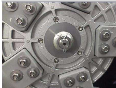
Führe den Sicherungssplint ein und biege die Enden um
